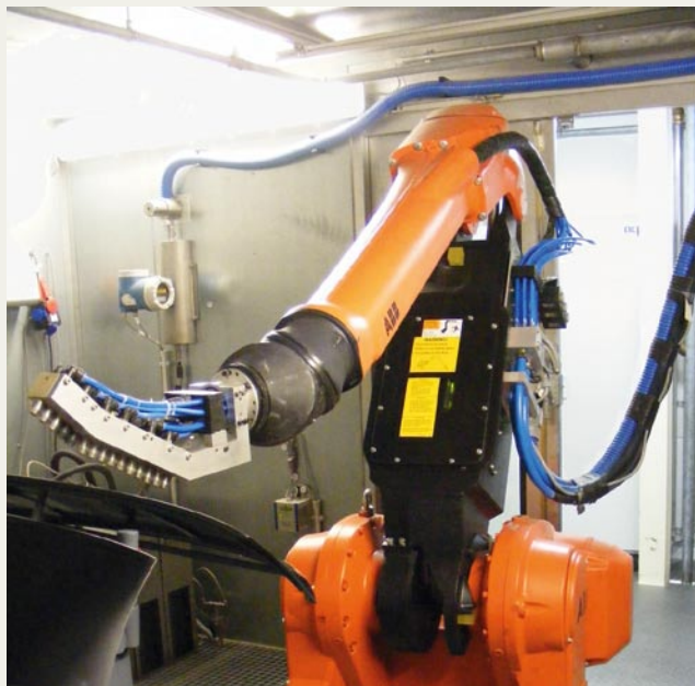
Ölfreie Druckluft und Kohlendioxid werden über den Roboterarm zugeführt (Innenhollow-Versorgung)
