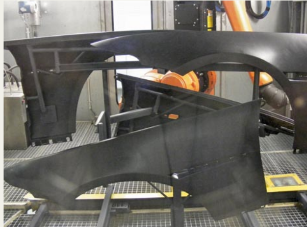
Das in eine Kabine integrierte CO 2 -Schneestrahlsystem benötigt deutlich weniger Platz als ein Powerwasher mit Trockner
