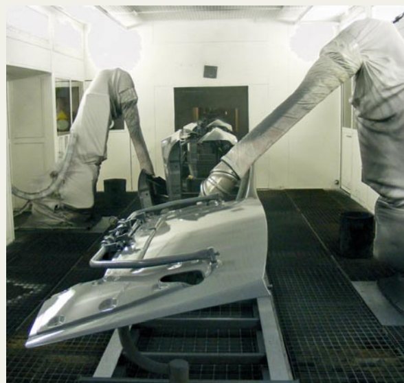
Der Haftgrundauftrag erfolgt mit mehreren Lackierrobotern
